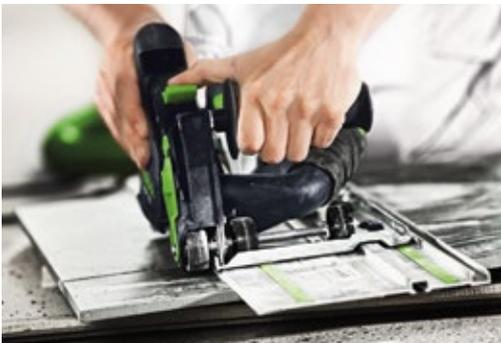
**Präzise Führung, saubere Arbeit:** Das Diamant-Trennsystem DSC-AG mit Führungsschiene für den genauen Zuschnitt von Fassadenplatten – und mit Absaugmobil für eine staubfreie Arbeitsumgebung.
