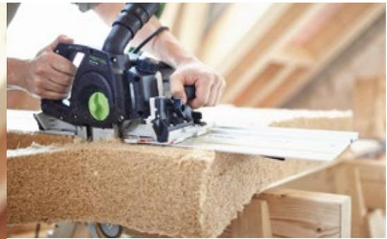
**Präzision pur:** Exakt, leicht, tief für den präzisen Zuschnitt von Holz und Dämmstoffen – die Schwertsäge UNIVERS SSU 200.
