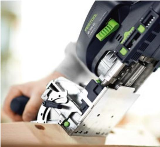
**Schnell mobil verbinden:** Selbst stabile Massivholzverbindungen gelingen mit der DOMINO XL einfach und präzise. Für die Verarbeitung von DOMINO Dübeln bis zu einer Größe von 14 x 140 mm. Egal ob für den Innen- oder Außenbereich – für jeden Fall gibt es die passenden DOMINO Dübel.
