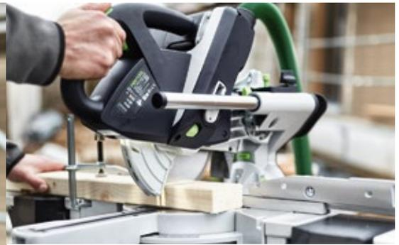
**Optimale Sicht auf den Anriss:** Das LED-Schlaglicht überträgt den Schlagschatten des Sägeblatts als exakte Schnittlinienanzeige auf das Werkstück.
