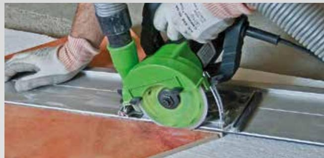
Maschine auf Führungsschiene (Anschlag für präzise Schnitte)
