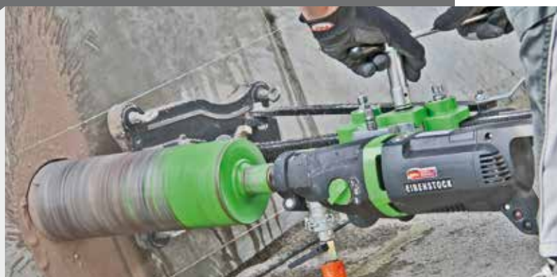
BST 182 V/S: auf vier Spezialkugeln gelagerter Schlitten
