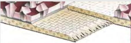
Überlappende Verbindung mit Kornabschliff
