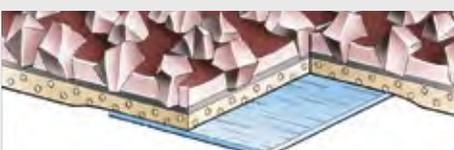
Gestossene Verbindung mit rückseitiger Spezialfolie
