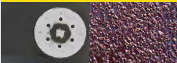
Schleifkorn auf einer Gewebe- oder Papierunterlage wird vollflächig in Bindemittel eingebettet und die Staubabsaugung über gestanzte Löcher ermöglicht. Das zusammengeklebte Korn hat wenig Raum, um Staub einzubinden, wodurch die Lebensdauer des Schleifmittels stark beeinflusst werden kann.
